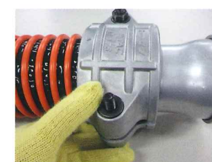
3. A型ホルダーを上側からかぶせ、ボルトを仮止めする。
